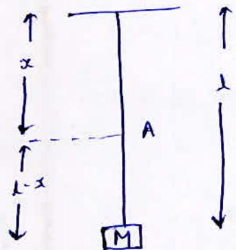
$$\text{Tensile Force} = Mg + (L-x)mg$$
