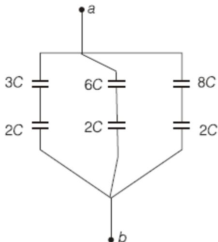
$$C_{eq} = \frac{(3C)(2C)}{3C+2C} + \frac{(6C)(2C)}{6C+2C} + \frac{(8C)(2C)}{8C+2C}$$
