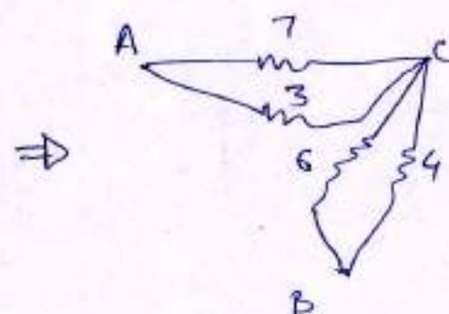
$$\Rightarrow A - \frac{7 \times 3}{10} \text{ ohms} \parallel \frac{6 \times 4}{10} \text{ ohms}$$
